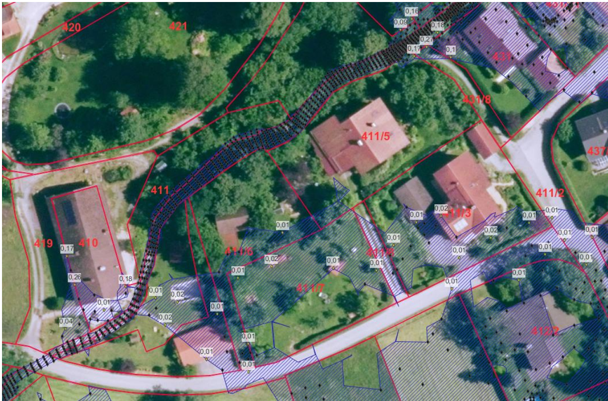
Abb. 13 Auszug aus Luftbild mit Parzellarkarte und Kennzeichnung der Wassertiefen HQextrem – ohne Maßstab
