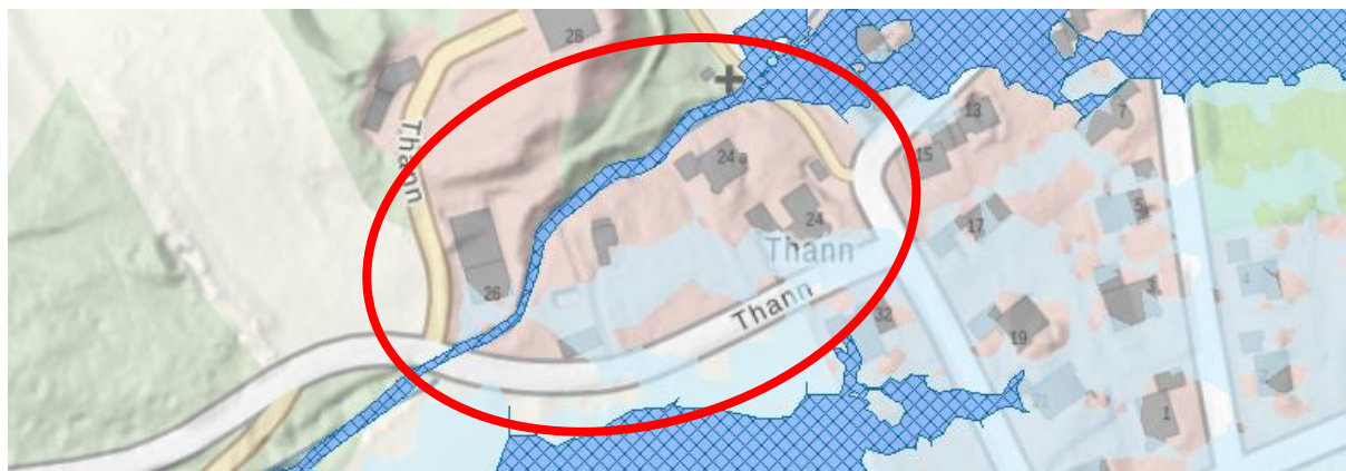
Abb. 12 Auszug aus Webkarte / Schummerung mit Darstellung der Hochwassergefahrenflächen HQextrem (hellblaue Flächensignatur) und der festgesetzten Überschwemmungsgebiete (HQ100, blaue Kreuzschraffur auf blauer Fläche) im Umfeld des Planungsgebiets (schematisch rot umrandet) – ohne Maßstab
