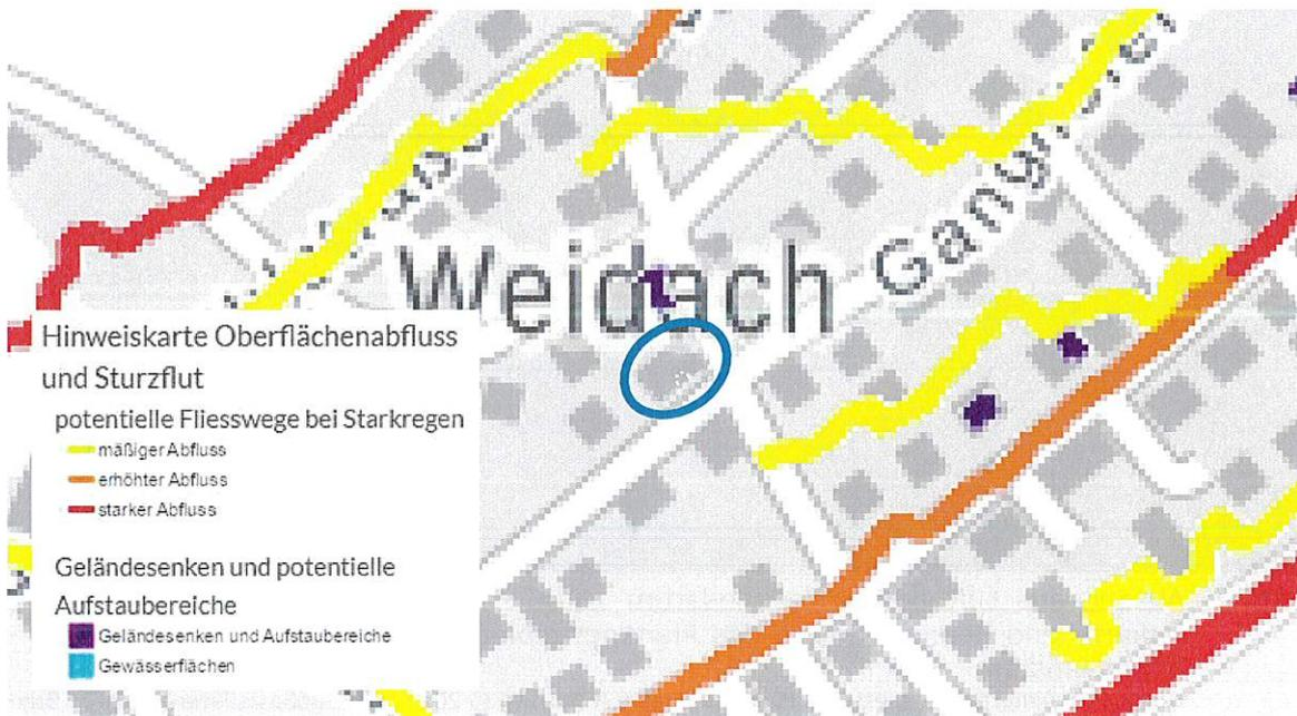
Abb. 4 Darstellung der potenziellen Fließwege bei Starkregen gemäß Hinweiskarte „Oberflächenabfluss und Sturzflut“ mit Kennzeichnung des Planungsgebiets (schematisch blau umrandet) – ohne Maßstab
